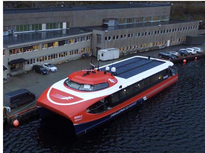
2022年交付的AERO 1 船體結構重量僅有21噸
